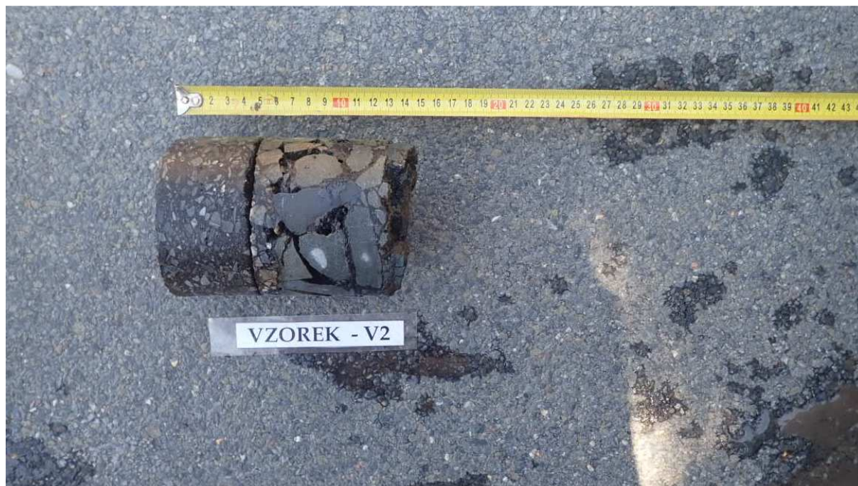
Obr. 1 - Jádru vývrtu Vzorek – V2 (in situ).
