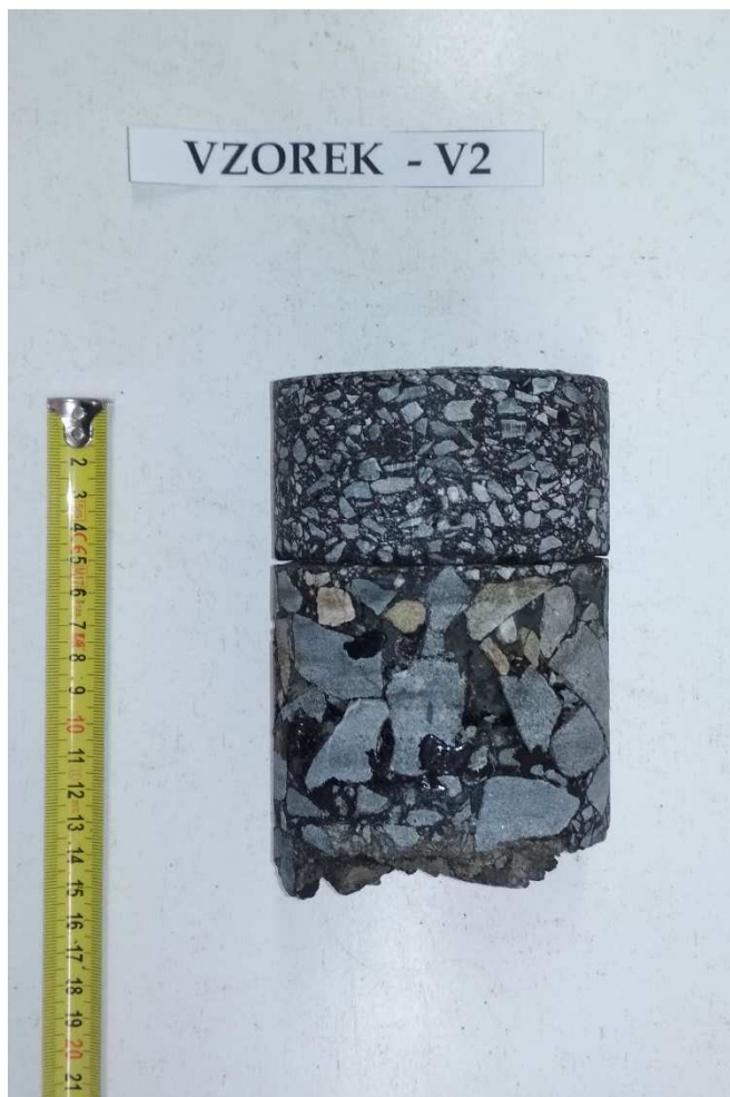
Obr. 2 - Jádru vývrtu Vzorek – V2 (laboratoř).
